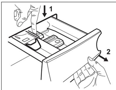
2. Um die Reinigung zu vereinfachen, entfernen Sie auch das Oberteil des Pflegemittelfachs. Stellen Sie sicher, dass alle Waschmittelreste an der Ober- und Unterseite der Aufnahme
