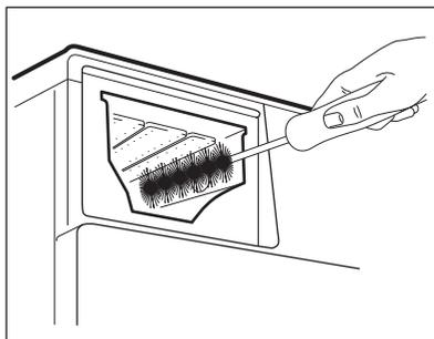
3. Spülen Sie die Waschmittelschublade unter fließendem warmen Wasser aus, um alle Waschmittelmittelrückstände zu entfernen. Setzen Sie nach der Reinigung das Oberteil wieder ein.
