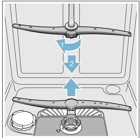
4. Sprüharme unter fließendem Wasser reinigen.
