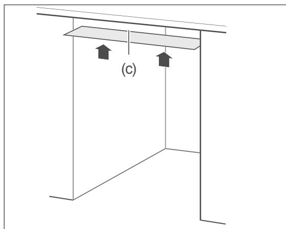
3. Kleben Sie die beiliegende Schutzfolie für Kondenswasser (c) auf die Unterseite der Arbeitsplatte. So vermeiden Sie Schäden an der Arbeitsplatte aufgrund heißer Dämpfe, die bei geöffneter Tür aus dem Geschirrspüler strömen.
