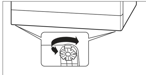
3. Um Unebenheiten des Bodens auszugleichen und den Geschirrspüler waagrecht auszurichten, können Sie die vier Gerätefüße heraus- oder hineindreihen. In den Gerätefüßen sind ringsherum Schlitze angebracht. Stecken Sie hier einen Schraubendreher hinein und drehen Sie damit den Gerätefuß.
