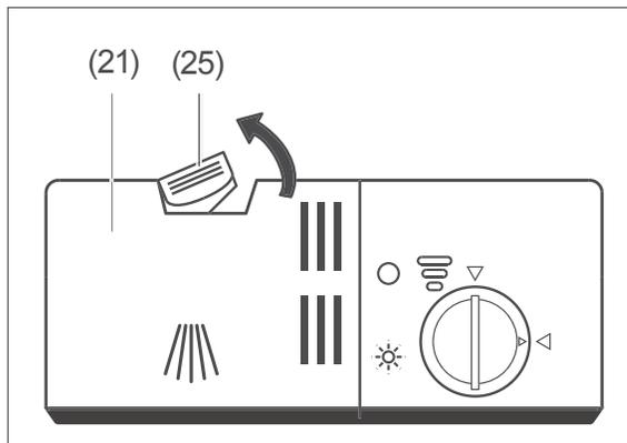
1. Ziehen Sie den Verschluss (25) der Spülmittelkammer (21) nach hinten. Der Deckel springt auf.
