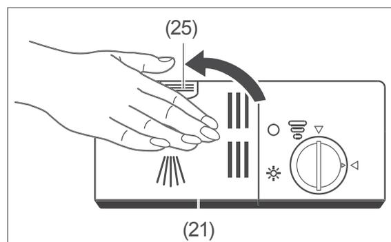
4. Drücken Sie den Deckel der Spülmittelkammer (21) zu, sodass der Verschluss (25) wieder einrastet.
