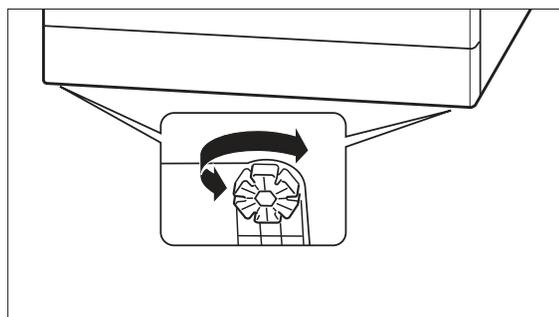
5. Um Unebenheiten des Bodens auszugleichen und den Geschirrspüler waagrecht auszurichten, können Sie die vier Gerätefüße heraus- oder hineindrehen. In den Gerätefüßen sind ringsherum Schlitz angebracht. Stecken Sie hier einen Schraubendreher hinein und drehen Sie damit den Gerätefuß. Verwenden Sie zum Ausrichten des Geschirrspülers eine Wasserwaage.
