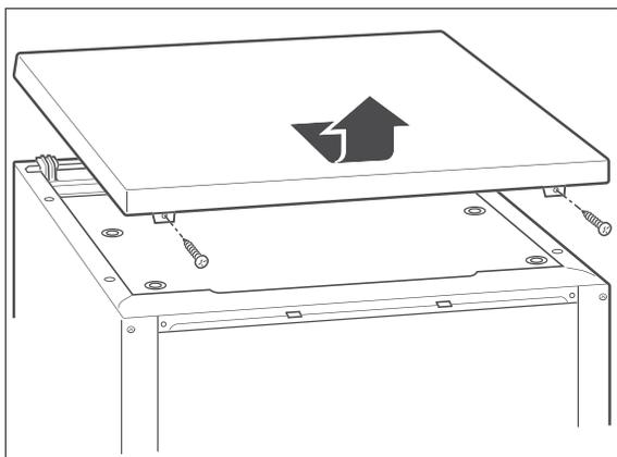
2. Lösen Sie die beiden Schrauben auf der Rückseite der Abdeckplatte und nehmen Sie diese ab.
