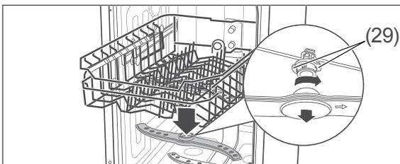
3. Der obere Sprüharm ist mit einem Bajonett-Verschluss befestigt. Zum Abnehmen des Sprüharms halten Sie die beiden gezackten Bajonettgriffe (29) fest und drehen Sie den Sprüharm im Uhrzeigersinn ab.
