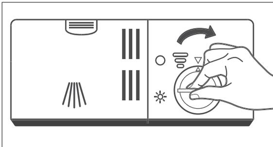
4. Setzen Sie den Verschluss der Klarspülerkammer (20) ein und drehen Sie ihn eine Viertelumdrehung im Uhrzeigersinn fest. Die Markierungen am Deckel und der Klarspülerkammer (20) müssen beim Einsetzen fluchten.
