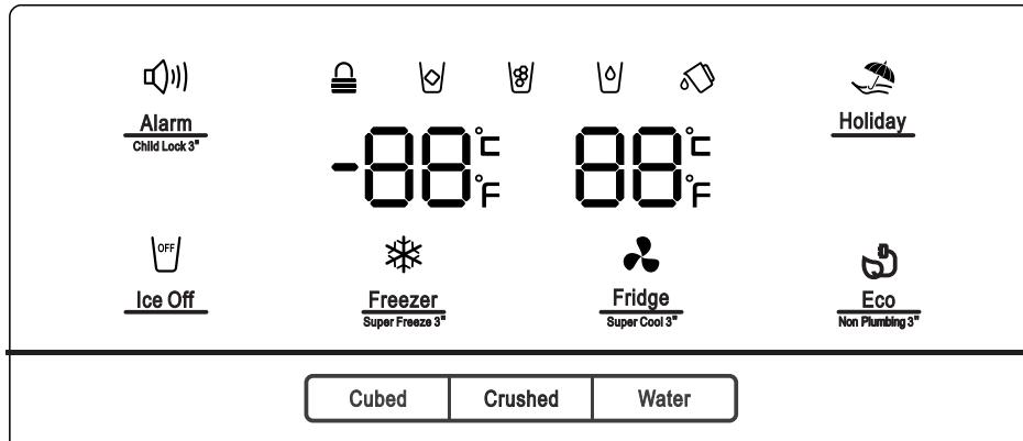
Lorsque l'appareil est mis sous tension pour la première fois, le rétroéclairage des icônes de l'écran commence à fonctionner. Si aucun bouton n'a été touché et que les portes sont fermées, le rétro-éclairage s'éteindra au bout de 60 secondes. Le tableau de commande comprend deux parties ayant rapport à la température et une partie ayant rapport aux différents modes.
