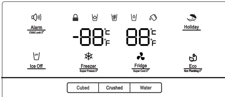
Quando si aziona il dispositivo per la prima volta, si attiva la luce posteriore delle icone sul quadro comandi. Se non sono stati toccati pulsanti e le porte sono chiuse, la retroilluminazione si spegne dopo 60 secondi.
