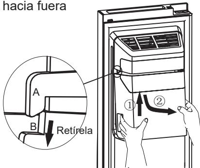
Cuando la coloque de nuevo, asegúrese de que ambos lados de la cubitera (B&B') están bien colocados en sus guías (A&A').
