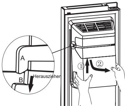
Wenn Sie ihn wieder einsetzen, stellen Sie sicher, dass die beiden Seiten (B&B') des Eisbehälters in die Kappen (A&A') einhaken.
