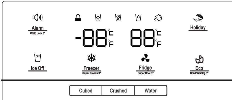
Als het apparaat wordt ingeschakeld voor de eerste keer, begint de achtergrondverlichting van de pictogrammen op het display te werken. Als er geen knoppen zijn aangeraakt en de deuren zijn gesloten, wordt de achtergrondverlichting na 60 seconden uitgeschakeld.
