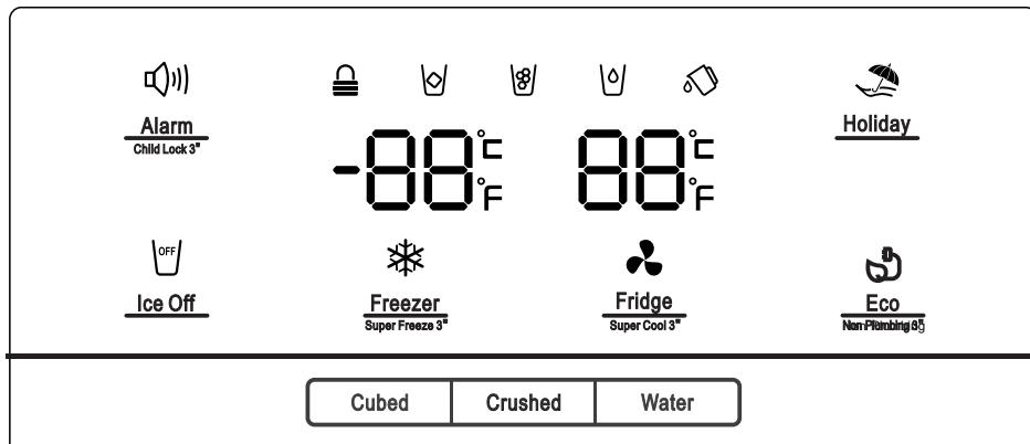
Wenn Sie das Gerät zum ersten Mal einschalten, beginnt die Hintergrundbeleuchtung der Symbole auf dem Bildschirm zu funktionieren. Wenn keine Tasten gedrückt worden und die Türen geschlossen sind, wird die Hintergrundbeleuchtung nach 60 Sekunden erlöschen.
