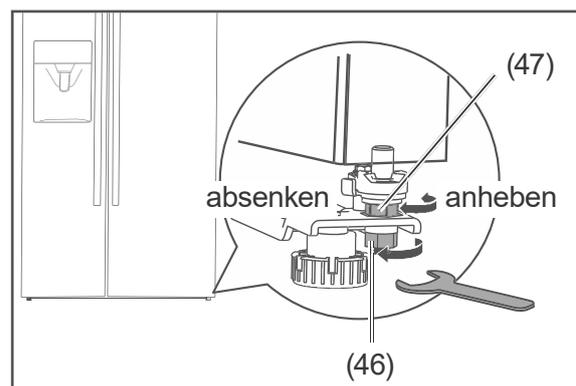
2. Drehen Sie die Sicherungsmutter (46) zwei volle Umdrehungen im Uhrzeigersinn, um sie zu lösen. Verwenden Sie dazu den mitgelieferten Schraubenschlüssel.
