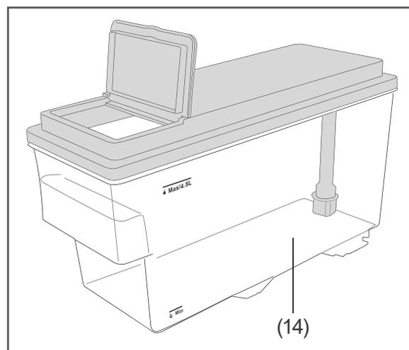
1. Öffnen Sie die Klappe und füllen Sie frisches, kaltes Leitungswasser in den Wassertank (14) über die "Min"-Markierung bis zur "Max"-Markierung (4,5 l).
