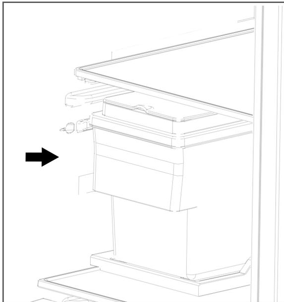
3. Schieben Sie den Wassertank wieder bis zum Anschlag ein, sodass er festsitzt.
