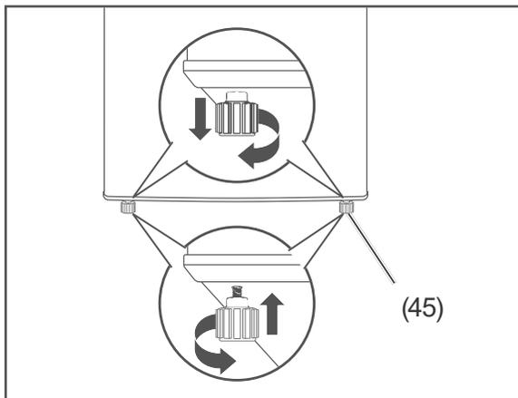
2. Gleichen Sie Unebenheiten des Untergrunds mithilfe der beiden vorderen Schraubfüße (45) aus.
