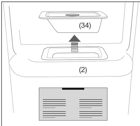
1. Entfernen Sie die Verschlussbox (34) aus dem Eisspender (2). Bewahren Sie die Verschlussbox gut auf, für den Fall, dass Sie den Eisbereiter sperren möchten.
