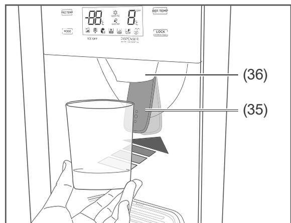
2. Halten Sie das Gefäß so dicht wie möglich an die Öffnung des Eisauslasses (36), um ein seitliches Danebenspritzen zu verhindern.
