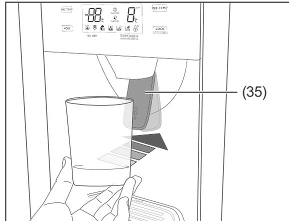
2. Drücken Sie das Gefäß gegen das Entnahme-Pad (35).
