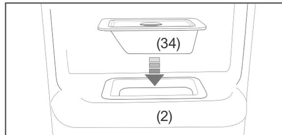
3. Verschließen Sie den Eisspender (2) mit der Verschlussbox (34), um Energie zu sparen.
