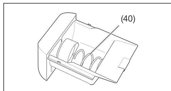
1. Entsorgen Sie eventuell vorhandene Eiswürfel im Abfluss. Bewegen Sie ggf. die Transportschnecke (40) im oder gegen den Uhrzeigersinn, um verkantete Eiswürfel zu lösen.
