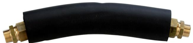
Der **Kollektorblockverbinder** dient zur **Verbindung von zwei direkt übereinander angeordneten Kollektorfeldern**. Er ist sowohl für die Aufdach- als auch für die Indachmontage geeignet und **UV-beständig** isoliert. Im Lieferumfang sind zudem zwei Verschluss-Stopfen enthalten.
