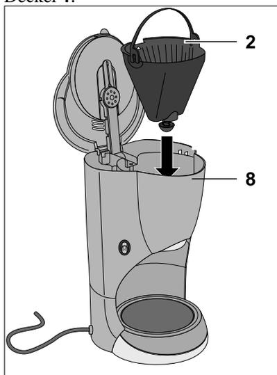
4. Setzen Sie den Filtereinsatz **2** in die Filteraufnahme **8** ein. Darauf achten, dass der Henkel nur nach vorne umgeklappt werden kann, damit er an den seitlichen Stiften richtig verriegelt.
