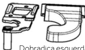
Dobradiça esquerda superior para reversibilidade da porta Tampa da dobradiça esquerda superior
