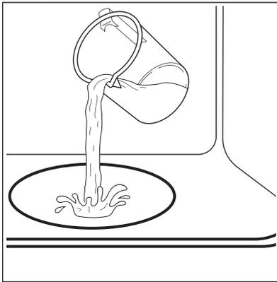
Die maximale Kapazität der Garraumvertiefung beträgt 250 ml. Füllen Sie die Garraumvertiefung nur bei kaltem Backofen mit Wasser.
