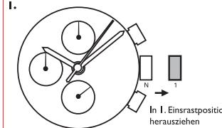
• Ziehen Sie die Krone in die 1. Einrastposition heraus sobald sich der Sekundenzeiger in der 12-Uhr-Stellung befindet.
