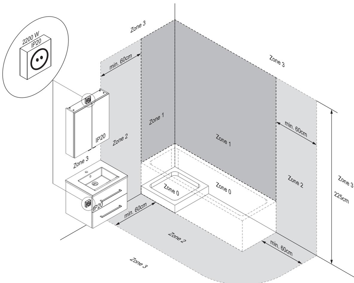
Der Netzanschluss über eine 230V-Steckdose (IP 20) darf nur in Zone 3 erfolgen.
