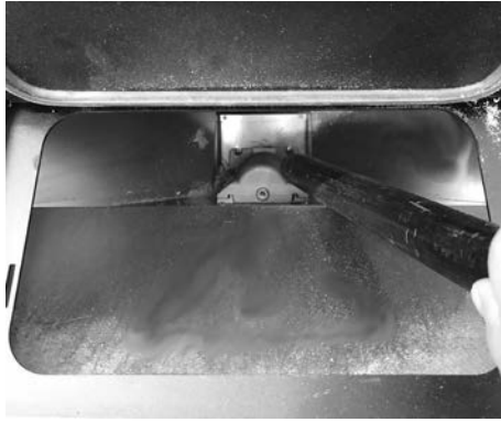
Fig. 33 - Reinigung Tank und Schnecke
