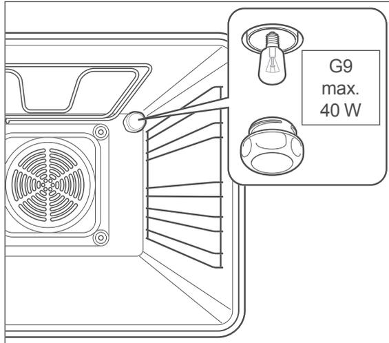
3. Schrauben Sie die Glasabdeckung gegen den Uhrzeigersinn ab und nehmen Sie sie heraus.
