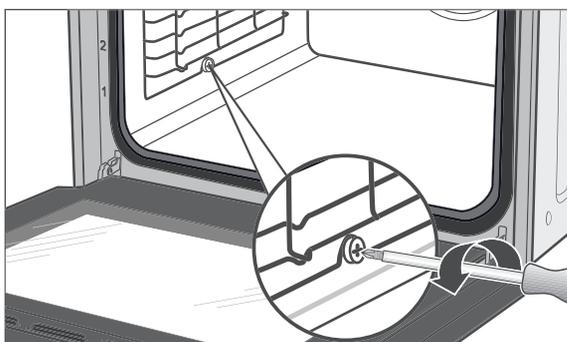
1. Lösen Sie die Schrauben am Backblechträger und nehmen Sie sie heraus.
