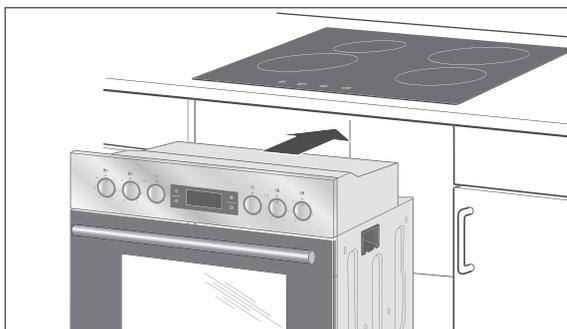
1. Heben Sie den Backofen an den seitlichen Tragemulden an und schieben Sie ihn so weit in den Einbauschrankschrank, dass die Anschlüsse und die Erdungsschraube für das Kochfeld noch gut zugänglich sind.
