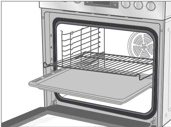
Der Gitterrost besitzt eine Erhöhung am hinteren Ende. Er muss mit der Erhöhung zuerst eingeschoben werden, so kann verhindert werden, dass Gargut an die Backofenwand gerät.
