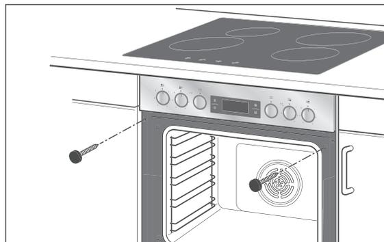
5. Schrauben Sie den Backofen mit den beiden mitgelieferten Schrauben am Einbauschrankschrank fest.
