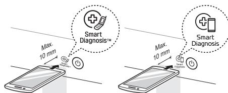
**3** Tenere premuto il pulsante **Temp.** per 3 o più secondi mentre si tiene il microfono dello smartphone sul logo fino al completamento del trasferimento dati.
