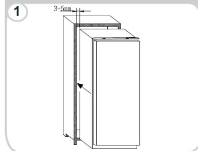
Après avoir vérifié que la porte de l'appareil et celle de la colonne coïncident, visser la partie supérieure de l'appareil sur le cabinet.
