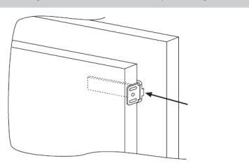
Marquer les points de fixation des vis et percer avec un foret de 2,5 mm de diamètre.
