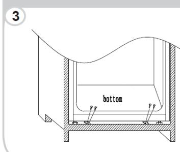
Ajuste o selo ao aparelho, corte o excedente se for necessário. Ajuste as partes inferiores com coberturas de plástico.
