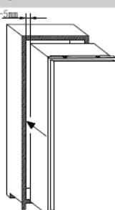
Po zapewnieniu pasowania między drzwiami urządzenia a drzwiami zabudowy meblowej, przykroić górną częścią urządzenia do szafki.
