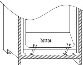
Ajuster le joint d'étanchéité de l'appareil, si nécessaire, découper la surlongueur. Fixer les pièces inférieures avec les caches plastiques.
