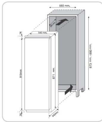
**INSTALLATION DE L'APPAREIL DANS LA COLONNE**
