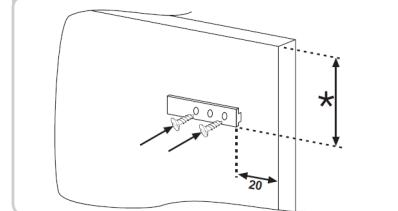
Abra as portas da coluna embutida e do frigorífico. Posicione o carregador embutido na corrediça e encaixe na porta do frigorífico.
