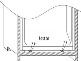
Ajuste o selo ao aparelho, corte o excedente se for necessário. Ajuste as partes inferiores com coberturas de plástico.
