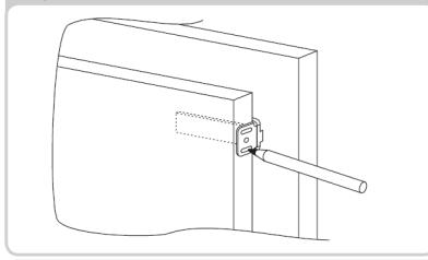
Die Gerätetur mit der Korpusfront verbinden und die Schlitze des Mitnehmers zur Ausrichtung verwenden.
