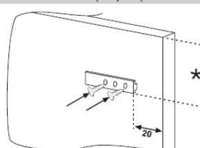
Otworzyć drzwi szafki i lodówki. Włożyć wbudowaną wkładkę do ślizgacza, a następnie przyłożyć do drzwi lodówki.
