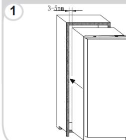
Nadat u ervoor gezorgd hebt dat er een overeenkomst is tussen de deur van het apparaat en de deur van de kastkast, schroeft u het bovenste deel van het apparaat aan de kast vast.
