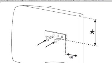
Abra as portas da coluna embutida e do frigorífico. Posicione o carregador embutido na corredela e encaixe na porta do frigorífico.
