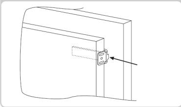
Σημειώστε τα σημεία στερέωσης για τις βίδες και ανοίξτε τρύπες με τρυπάνι διαμέτρου 2,5 mm.
