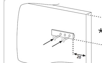
Ouvrir les portes de la colonne encastrée et du réfrigérateur. Positionner le support encastré dans la glissière, et ensuite l'introduire dans la porte du réfrigérateur.
