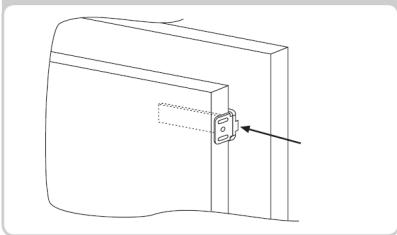
Marque os pontos de fixação para os parafusos e perfure com uma broca de 2.5mm de diâmetro.
