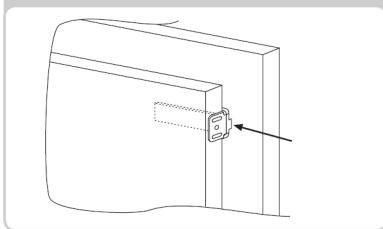
Markeer de bevestigingspunten voor de schroeven en boor met een bit van 2,5 mm diameter.
