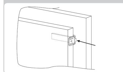
Marque os pontos de fixação para os parafusos e perfure com uma broca de 2.5mm de diâmetro.
