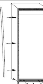
**ASSEMBLAGE DES PANNEAUX DE LA COLONNE ENCASTREE DES PORTES DE L'APPAREIL**
