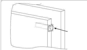
Contrassegnare i punti di fissaggio per le viti e praticare i fori utilizzando un trapano con una punta di 2,5 mm di diametro.
