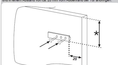
Beide Türen (Gerät und Korpusfront) öffnen. Den Mitnehmer in die Schiene und dann an die Kühlzentraltür anlegen.
