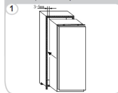
Zkontrolujte zarovnání dveří spotřebiče a skříně a poté přišroubujte horní část spotřebiče ke skříni.
