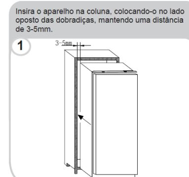
Após se assegurar da correspondência entre a porta do aparelho e a porta da coluna, aparafuse a parte superior do aparelho ao armário.
