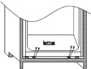
Umístěte těsnění spotřebiče, v případě potřeby uřízněte přecípavající část. Na spodní část nasadte plastové kryty.
