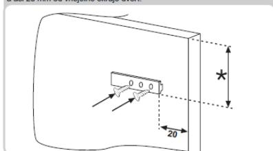
Otevřete dveře skříně a ledničky. Umístěte vestavěný zaváděč do kolejničky a upevněte na dveře ledničky.
