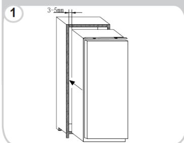
Accertarsi che lo sportello dell'elettrodomestico sia allineato all'anta dell'incasso e avvitare la parte superiore dell'elettrodomestico al vano
