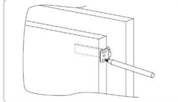
Collegare lo sportello dell'elettrodomestico al pannello del vano utilizzando le scanalature della slitta come guida.
