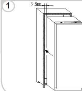
Die korrekte Ausrichtung der Gerätetür zur Korpusfront prüfen und die Oberseite des Geräts am Korpus festschrauben.
