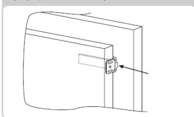
Označte body pro šrouby a vyroutejte otvory vrtákem o průměru 2,5 mm.
