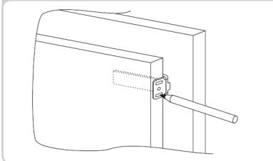
Verbind de apparaatdeur met het kastpaneel en gebruik de ladersleuven als richtlijn.
