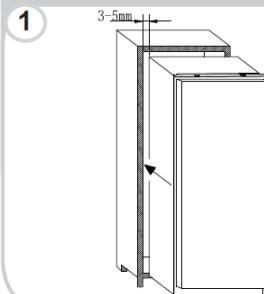
Após se assegurar da correspondência entre a porta do aparelho e a porta da coluna, aparafuse a parte superior do aparelho ao armário.
