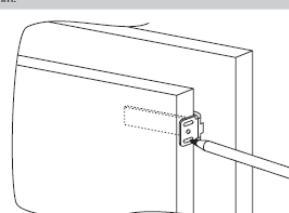
Połączyc drzwi urządzenia z panelem szafki, wykorzystując szczelinę wkładki jako prowadnice.
