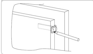
Marquer les points de fixation des vis et percer avec un foret de 2,5 mm de diamètre.
