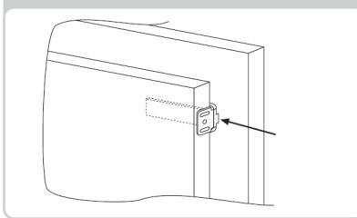
Die Befestigungspunkte für die Schrauben markieren und mit einer Bohrspitze von 2,5 mm anbohren.
