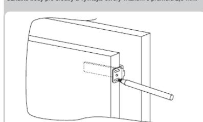
Připevněte dveře spotřebiče k panelu skříně a použijte při tom zaváděče pro určení polohy.
