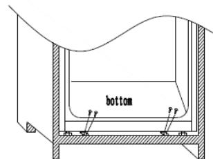
Złożyć uszczelkę na urządzenie, w razie potrzeby odcinając nadmiar. Zamontować w dolnej części plastikowe pokrywy.
