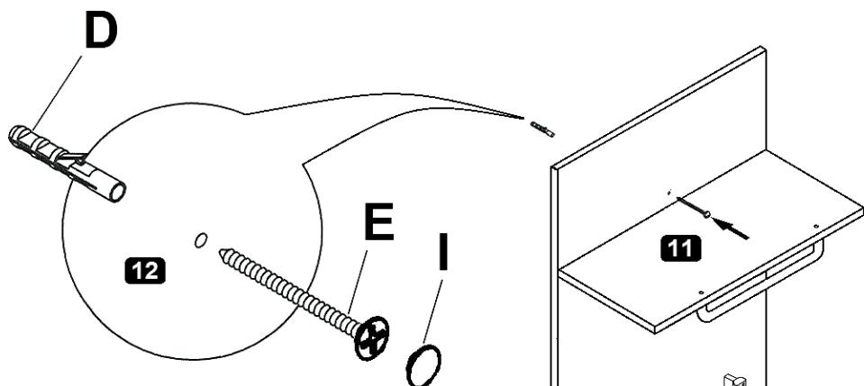
**D** Das beigefügte Wandbefestigungsmaterial (Dübel und Schrauben) eignet sich nur für festes Mauerwerk (z.B. Beton- oder Ziegelwände). Für andere Wandaufbauten sind eventuell Spezialdübel und andere Schrauben notwendig. Ziehen Sie gegebenenfalls eine Fachkraft zurate.
