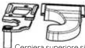
Cerniera superiore sini- stra per la reversibilità dello sportello
