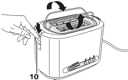
1. Drücken Sie den Bedienehebel **10** für die Brötchen-Röstaufgabe herunter, sodass die Brötchen-Röstaufgabe **2** nach oben geklappt wird.
