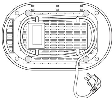
Unter dem Toaster befindet sich eine Kabelaufwicklung. Hiermit können Sie die Kabellänge bei Bedarf verkürzen.
