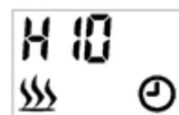
Due brevi segnali acustici che aumentano il tono del suono quando sono attivati e tre segnali acustici che diminuiscono nel suono del suono quando sono spenti. All'accensione, vengono visualizzati il livello di riscaldamento, l'impostazione della temperatura e l'icona dell'orologio. Il display scomparirà dopo 60 secondi senza alcuna operazione. Premere qualsiasi tasto per visualizzare di nuovo.
