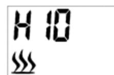
Appuyez sur le bouton E ou F pour régler la température. Si la température réglée est supérieure à la température ambiante détectée par l'appareil, le chauffage démarre. Le chauffage ne démarre pas si la température réglée est inférieure à la température ambiante.
