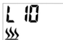
Appuyez sur le bouton E ou F pour régler la température. Si la température réglée est supérieure à la température ambiante détectée par l'appareil, le chauffage démarre. Le chauffage ne démarre pas si la température réglée est inférieure à la température ambiante.
