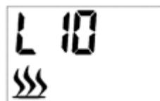
Drücken Sie Taste E oder F, um die Temperatur einzustellen. Danach die Taste C zur Bestätigung und die Taste D um andere Funktionen einzustellen.
