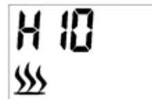
Premere il pulsante E o F per regolare la temperatura. Se la temperatura impostata è superiore alla temperatura ambiente rilevata dall'apparecchio, inizia il riscaldamento. Il riscaldamento non si avvia se la temperatura impostata è inferiore alla temperatura ambiente.
