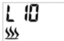
Druk op knop E of F om de temperatuur aan te passen. Als de ingestelde temperatuur hoger is dan de kamertemperatuur die door het apparaat wordt gedetecteerd, begint de verwarming. De verwarming start niet als de ingestelde temperatuur lager is dan de kamertemperatuur.
