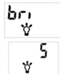
Premere il pulsante C per avviare l'impostazione della luminosità. Premere il pulsante E o F per selezionare il livello di luminosità.
