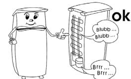
Lisäksi rungon sivu saattaa kuumeta. Tämä lämpö syntyyn kaapin sisällä syntyneen lämmön hajaantumisesta.
