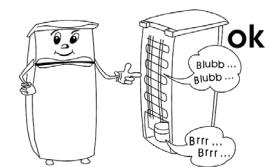
Por otra parte, la superficie lateral exterior se calentará. Este calor está producido por la disipación del calor generado en el interior de la vinoteca.
