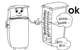
I tillæg kan siden af kabinetet blive varm. Denne varme skyldes det varmetab som genereres inde i kabinetet.
