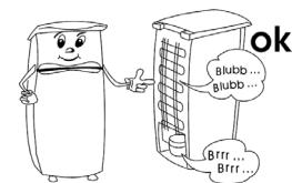
Tevens, de zijkant van de behuizing kan warm worden. Deze hitte is wordt veroorzaakt door de afgifte van de hitte ontwikkeld in de kast.
