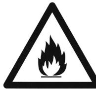
Das Gerät enthält das umweltfreundliche, jedoch brennbare Kältemittel Isobutan (R600a). Daher ist darauf zu achten, dass das Kältesystem beim Transport und auch nach Aufstellung des Gerätes geschützt wird. Bei Beschädigung des Systems darf das Gerät nicht in Betrieb genommen werden. Offenes Feuer oder Zündquellen in der Nähe des Kältemittels entfernen und den Raum gut lüften.
