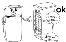
Кроме того, одна сторона корпуса может нагреваться. Это происходит из-за рассеивания тепла, генерируемого в шкафу.
