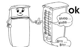
Inoltre, la parte laterale della cassa esterna può diventare calda. Questo calore è determinato dalla dispersione del calore generato all'interno della cantinetta.
