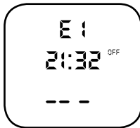
Predgrijanje isključeno / »OFF«
