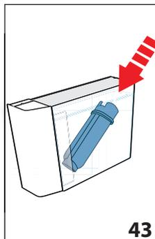
7. „FILTER EINTAUCHEN UND LUFT ENTWEICHEN LASSEN“ (Abb. 43): Den Filter in den Wassertank geben und für etwa zehn Sekunden vollständig eintauchen, dabei neigen und leicht andrücken, um das Entweichen der Luftblasen zu ermöglichen. Den Auswahlpfeil für „NEXT>“ drücken;
