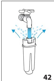
5. „WASSER LAUFEN LASSEN BIS ES AUSTRITT“ (Abb. 42): Um den Filter zu aktivieren, wie auf der Abbildung gezeigt, Leitungswasser in die Öffnung des Filters laufen lassen, bis das Wasser mindestens eine Minute lang aus den seitlichen Öffnungen austritt. Den Auswahlpfeil für „NEXT>“ drücken;
