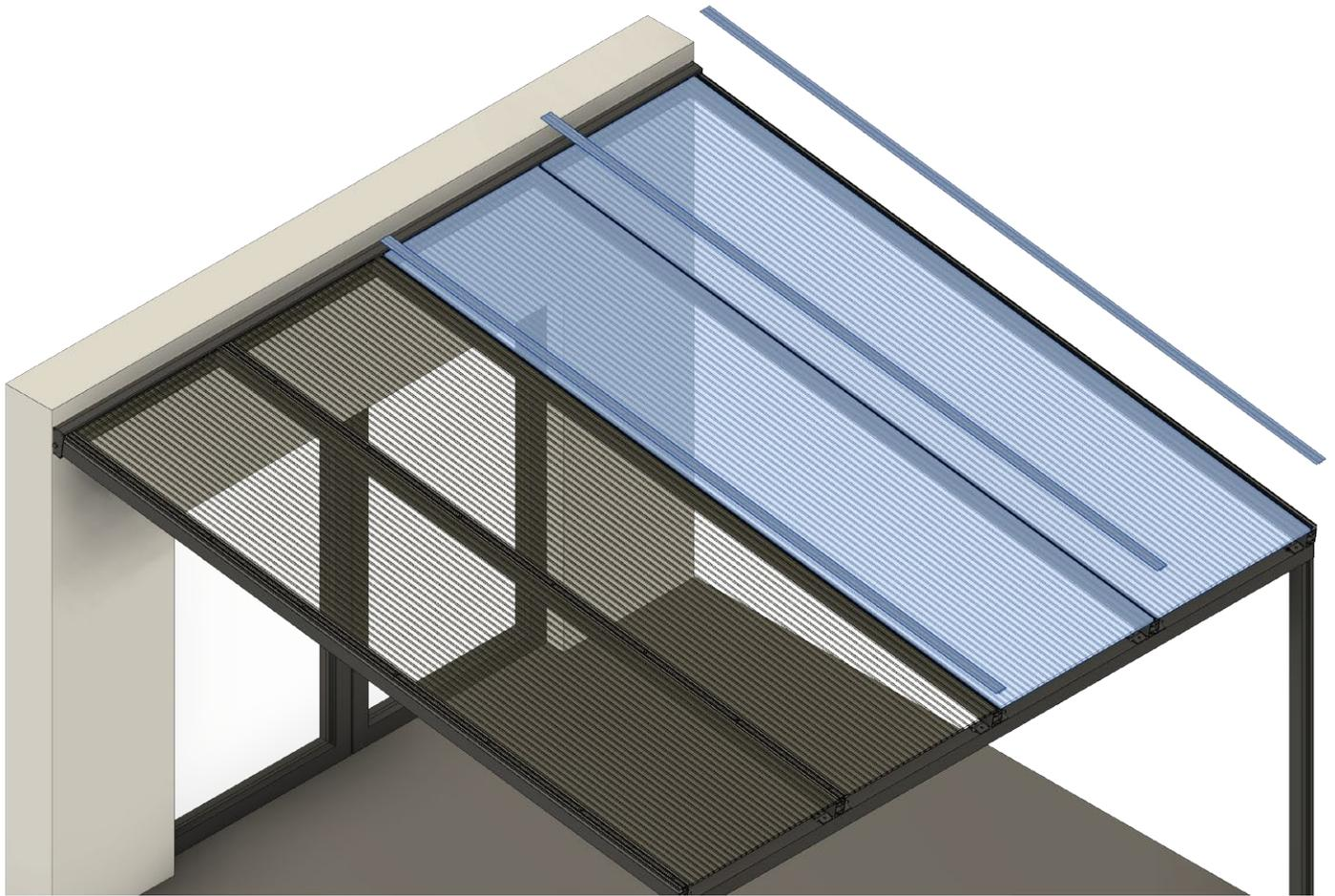
Montieren Sie in der gleichen Art und Weise die 3. und 4. Platte und verschrauben Sie diesen Deckel wie im Schritt 15. Ziehen Sie anschließend die Schutzfolien ab.
