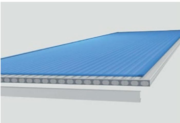
Stecken Sie nun die Alu-U-Abschlussprofile an den Stirnseiten auf. Achten Sie darauf, dass die gekennzeichnete Schutzfolie oben ist. UV-Schutz bei einseitig geschützten Platten! Die Tropfnase des Profils zeigt nach unten.
