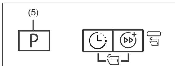
2. Halten Sie die Taste **P** (5) so lange gedrückt, bis im Display der aktuelle Härtegrad angezeigt wird: H1 bis H6.
