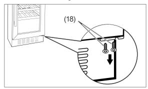
2. Schrauben Sie die beiden Schrauben (18) aus dem unteren Scharnier heraus.
