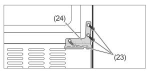
7. Lösen Sie die drei Schrauben (23) des unteren Scharniers (24) und nehmen Sie es ab.
