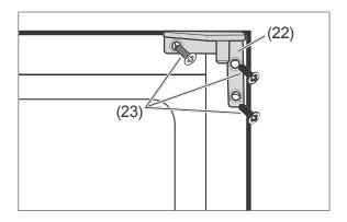
6. Lösen Sie die drei Schrauben (23) des oberen Scharniers (22) und nehmen Sie es ab.
