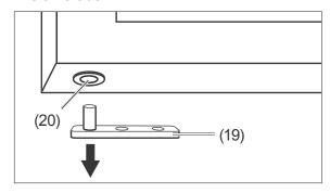
4. Ziehen Sie die Scharnierplatte (19) aus dem Kunststoffeinsatz (20) an der Unterkante der Glastür heraus.
