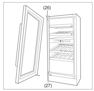
Setzen Sie die Glastür zunächst in das obere Scharnier (26) ein, dann auf das untere Scharnier (27).
