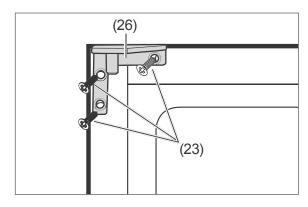
Schrauben Sie das mitgelieferte obere Scharnier für den Linksanschlag (26) mithilfe der Schrauben (23) fest.
