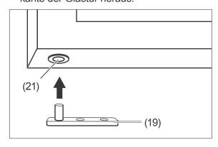
5. Drehen Sie die Glastür um 180° und setzen Sie die Scharnierplatte (19) hier in den Kunststoffeinsatz (21) ein.
