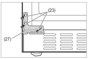
Schrauben Sie das mitgelieferte untere Scharnier für den Linksanschlag (27) auf der anderen Seite mithilfe der Schrauben (23) fest.
