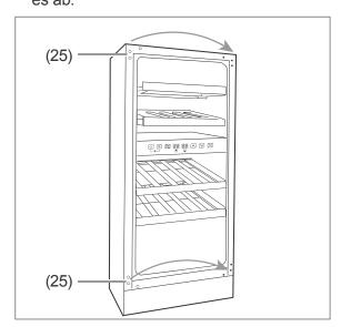
8. Ziehen Sie die 6 Blindstopfen (25) aus den Gewindelöchern oben und unten heraus und setzen Sie sie in den Gewindelöchern auf die gegenüberliegende Seite ein.
