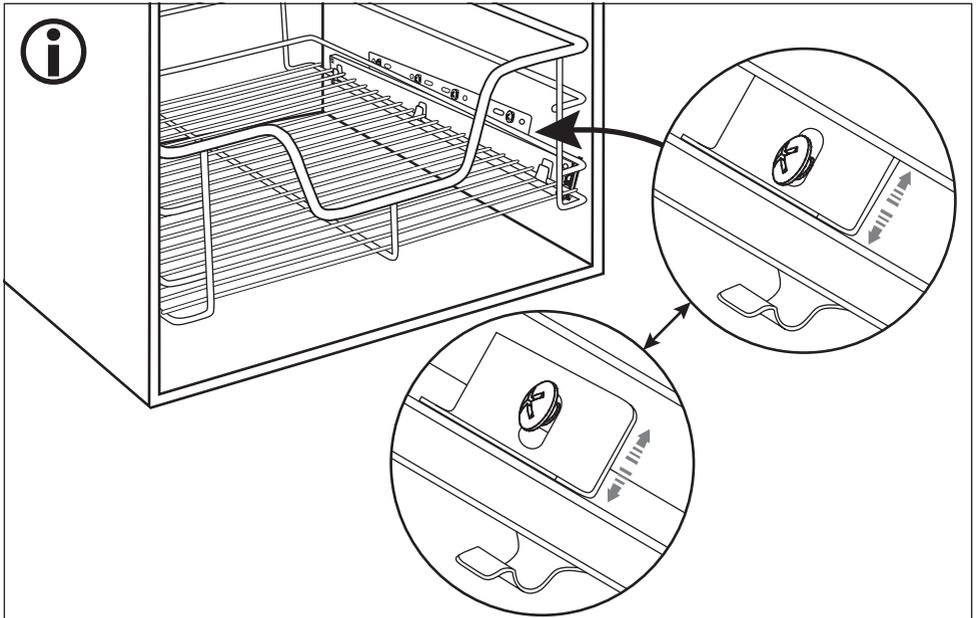
Sollte der Abstand zwischen Teleskopschublade und Halterung zu groß sein, können Sie durch leichtes Lösen der beiden Schrauben zwischen Befestigungs- und Auszugsschiene den Abstand angleichen. Anschließend ziehen Sie beide Schrauben wieder an.
