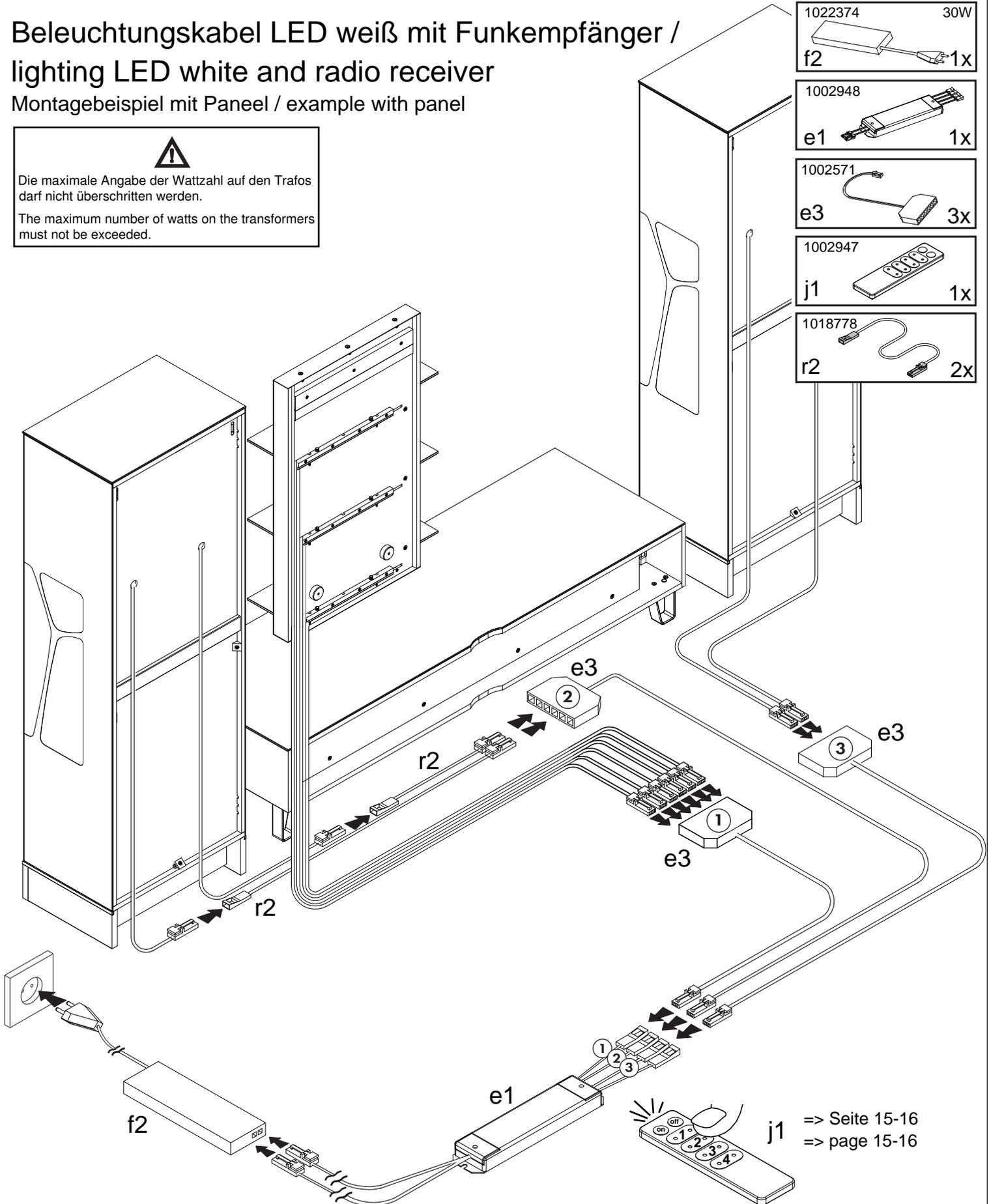
Vor der Montage der Möbel müssen alle elektrischen Anschlüsse (Fußschalter, Funksteuerung) und Trafos verlegt werden. es sollten alle Leuchten angeschlossen und getestet werden.
