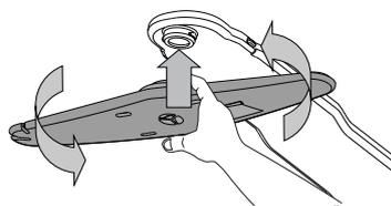
Um den oberen Sprüharm abzunehmen, diesen nach oben drücken und gegen den Uhrzeigersinn drehen. Der Sprüharm wird wieder eingebaut, indem er nach oben gezogen und im Uhrzeigersinn gedreht wird.
