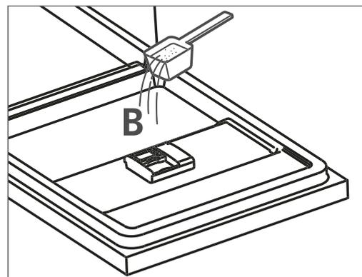
3. Geben Sie die restlichen 1/5 des Geschirrspülmittels auf die Innenseite der Tür. Diese Menge verwendet das Gerät während des Vorspülprogramms.
