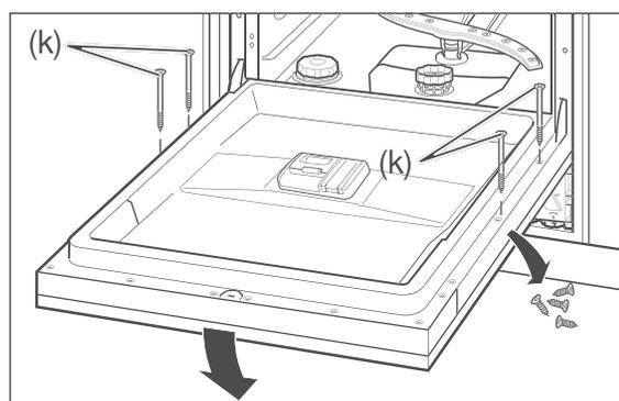
17. Entfernen Sie die 4 Schrauben an der Innenseite der Tür. Schrauben Sie die Möbelfrontplatte an diesen Positionen mithilfe der beiliegenden 4 Schrauben (j) fest.
