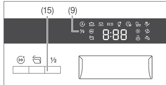
Wählen Sie die Option „Halbe Beladung“, wenn Sie das Gerät mit weniger als 6 Geschirren betreiben möchten. Der Wasser- und Stromverbrauch wird durch diese Zusatzoption reduziert.
