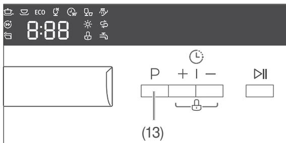
2. Halten Sie die Taste **P** (13) so lange gedrückt, bis im Display der aktuelle Härtegrad angezeigt wird: H1 bis H5.
