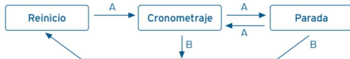
**REINICIO DEL CRONÓMETRO [incluso después de cambiar la batería]**
