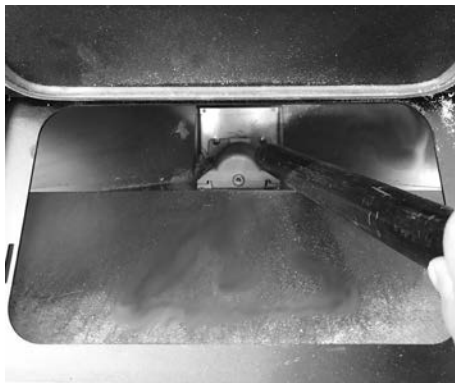
Fig. 33 - Reinigung Tank und Schnecke
