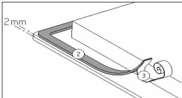
Die Dichtung (2) nach Abnehmen der Schutzfolie (3) mit 2 mm Abstand zu der Außenkante des Glases aufkleben.
