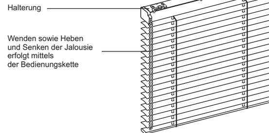
Wenden sowie Heben und Senken der Jalousie erfolgt mittels der Bedienungskette
