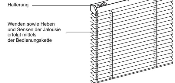
Wenden sowie Heben und Senken der Jalousie erfolgt mittels der Bedienungskette
