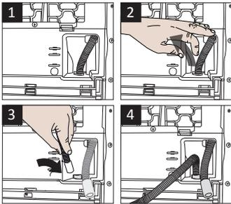
**i** Der Ablaufschlauch sollte in einer Höhe von maximal 80 cm angeschlossen werden.
