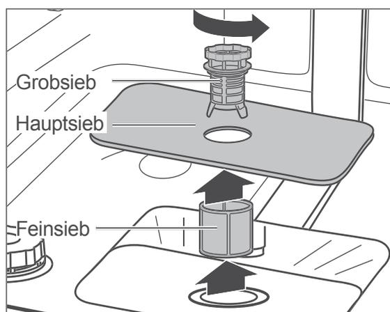
Überprüfen Sie nach jedem Spülgang das Grobsieb, das Hauptsieb und das Feinsieb, und entfernen Sie ggf. Speisereste und Fremdkörper.
