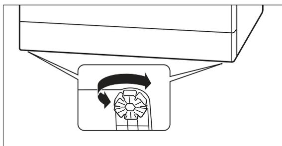
5. Um Unebenheiten des Bodens auszugleichen und den Geschirrspüler waagrecht auszurichten, können Sie die vier Gerätefüße heraus- oder hineindreuen. In den Gerätefüßen sind ringsherum Schlitz angebracht. Stecken Sie hier einen Schraubendreher hinein und drehen Sie damit den Gerätefuß. Verwenden Sie zum Ausrichten des Geschirrspülers eine Wasserwaage.
