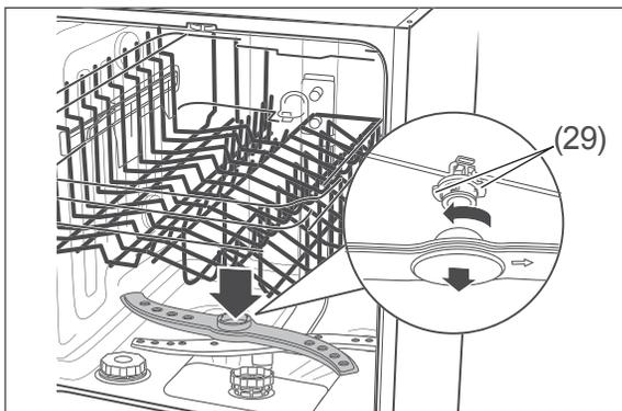
3. Der obere Sprüharm ist mit einem Bajonett-Verschluss befestigt. Zum Abnehmen des Sprüharms halten Sie die beiden gezackten Bajonettgriffe (29) fest und drehen Sie den Sprüharm im Uhrzeigersinn ab.
