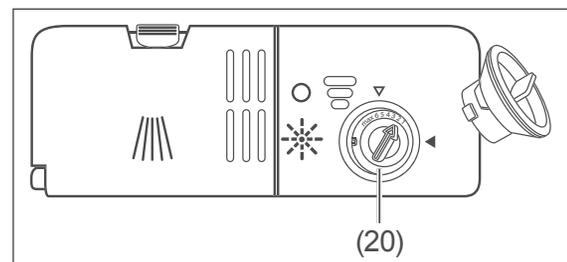
1. Drehen Sie den Deckel der Klarspülmittelkammer (20) eine Viertelumdrehung gegen den Uhrzeigersinn und nehmen Sie ihn heraus.
