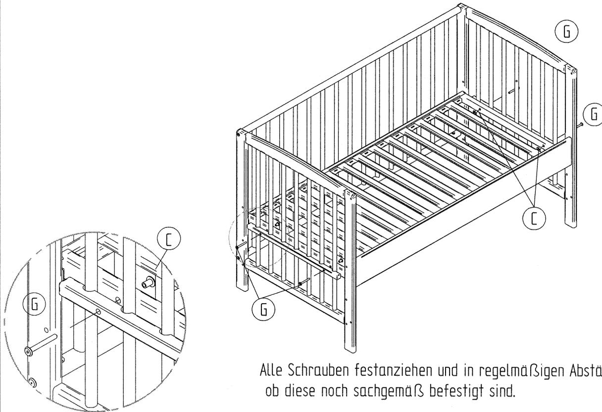
Alle Schrauben festziehen und in regelmäßigen Abständen kontrollieren, ob diese noch sachgemäß befestigt sind.
