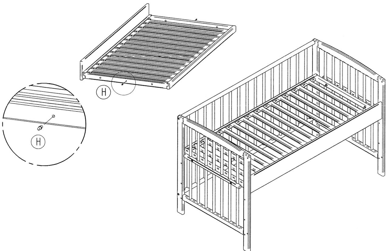
Bei Einbau des Rostes in die höchstmögliche Position bitte den Sicherungsstift (H) einsetzen. Oberhalb dieser Position darf das Rost nicht eingebaut werden.
