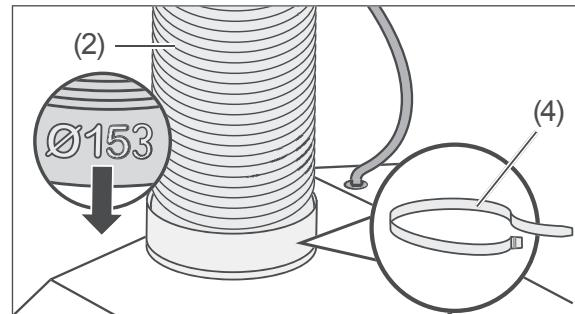
1. Stecken Sie das Ende des Abluftschlauchs (2) mit dem größeren Durchmesser (153mm) auf den Anschluss mit der Rückenschlagklappe (3).
