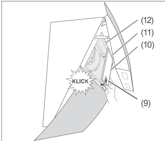
5. Setzen Sie den Fettfilter (10) mit den Zapfen (11) in die Aussparungen (12).
