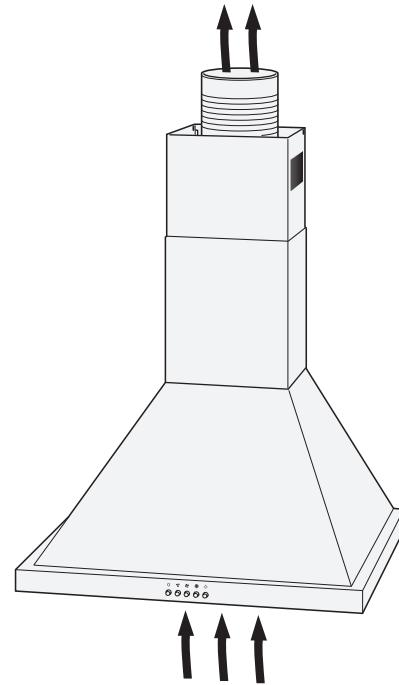
Die Grafiken zeigen **an einem Beispiel**, wohin die angesaugten Dämpfe geleitet werden. Sie zeigen nicht das hier beschriebene Gerät.
