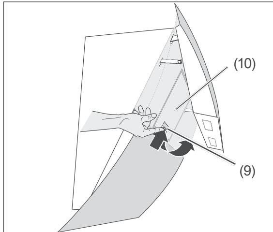
3. Lösen Sie die Verriegelung (9) des Fettfilters (10) und entnehmen Sie den Fettfilter vorsichtig.
