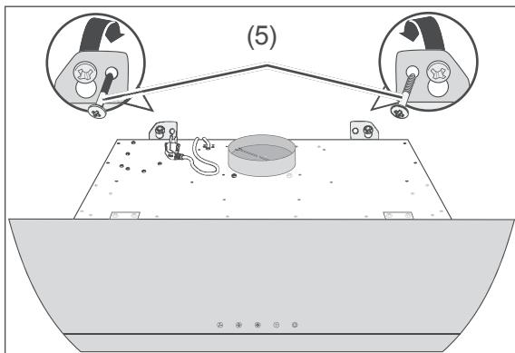
5. Drehen Sie zwei Rundkopfschrauben (5) zum Sichern der Dunstabzugshaube in die vorbereiteten Dübel und schrauben Sie die Dunstabzugshaube an der Wand fest.
