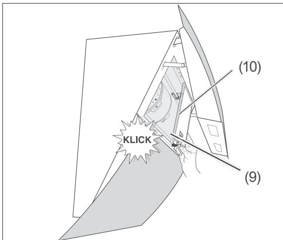
6. Setzen Sie den Fettfilter (10) mit den Zapfen in die Aussparungen.
