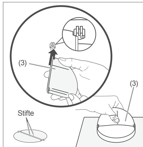
1. Setzen Sie die beiden Hälften der Rückschlagklappe (3) in die Öffnung oben auf die Dunstabzugshaube (1). Achten Sie darauf, dass die Stifte auf den Klappen außen liegen.
