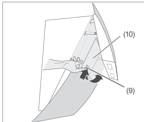
3. Lösen Sie die Verriegelung (9) des Fettfilters (10) und entnehmen Sie den Fettfilter (10) vorsichtig.
