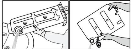
3. Falls sich Fusseln im Trichter des Wassertanks angesammelt haben sollten, entfernen Sie diese unter fließendem Wasser.
