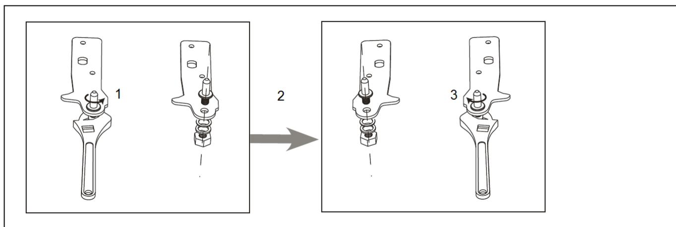
Den Stift vom unteren Scharnier lösen (1), das Scharnier um 180° drehen (2) und den Stift wieder einstecken (3).
