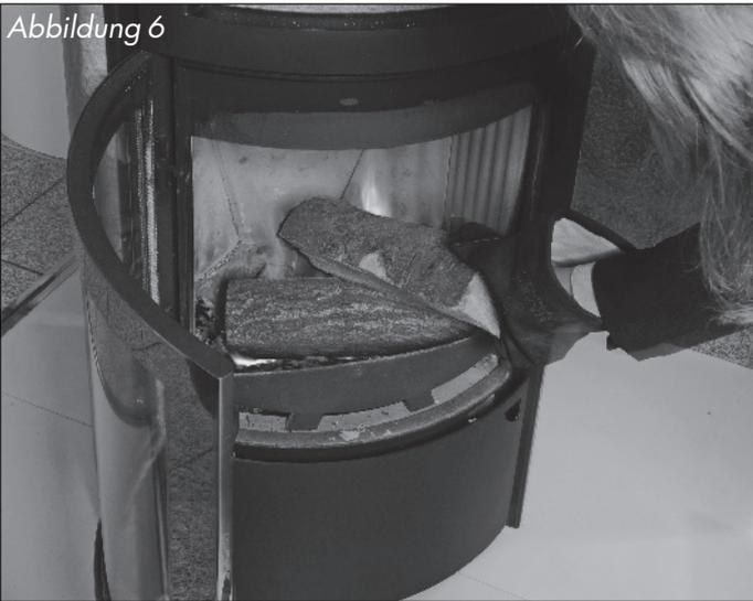
Sind auch diese Holzstücke rundherum angebrannt, sollten Ofen und Abgassystem weitgehend die Betriebstemperatur erreicht haben. Jetzt können Sie den Primärluftregler schließen und die Verbrennung hauptsächlich über den Sekundärluftregler regeln (Abb. 7).
