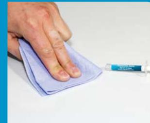
**Schritt 6:** Zum Schluss etwas Polierpaste auftragen und mit dem Poliertuch ausreiben.
