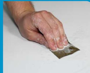
**Schritt 5:** Dann die Stelle mit dem Schleifpapier P1200 und etwas Wasser schleifen und später mit P2000.
