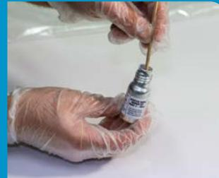
**Schritt 2:** Lassen Sie die Mischung 5 Minuten stehen, Sie haben 15 Minuten zum Verarbeiten.
