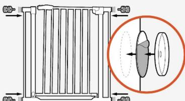
Alle 4 Klemmschrauben seitlich in das Gitter stecken & Wandteller an die Wand kleben.
