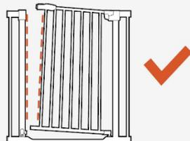
Die anfängliche Schiefstellung ist normal und verschwindet durch das Anziehen der Schrauben.
