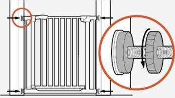
Gitter in den Durchgang platzieren & die 4 Klemmschrauben gleichmäßig fest anziehen.
