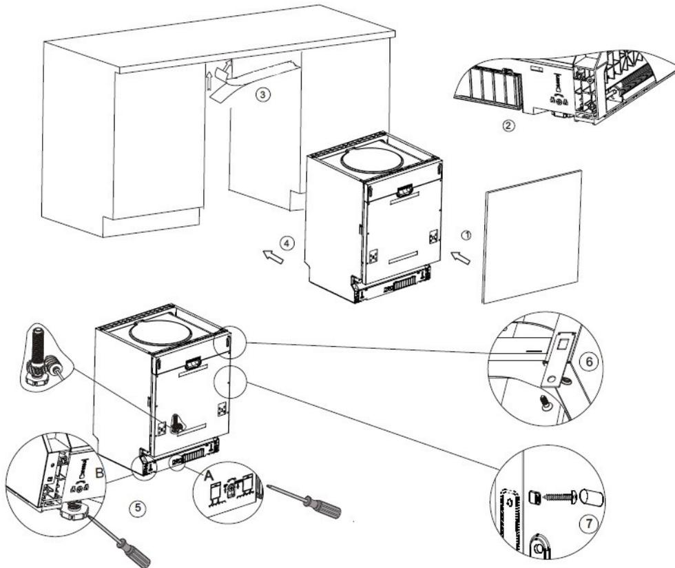
1. Befestigen Sie die Blende mit den beigefügten Klammern an der äußeren Spülmaschinentür. Siehe Vorlage bezüglich der Positionierung der Klammern.
