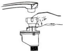
Verbinden Sie den Wasserzufuhrschlauch mit einem  $\frac{3}{4}$ " Gewindeanschluss und ziehen Sie das Ganze gut fest.
