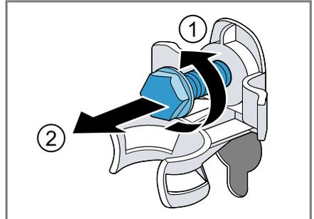
3. Die Netzanschlussleitung von der Halterung entfernen.
