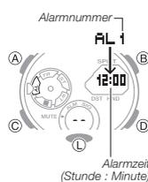
Sie können fünf getrennte tägliche Alarmer einstellen. Wenn ein täglicher Alarm eingeschaltet ist, ertönt täglich etwa 10 Sekunden lang ein Alarmton, sobald die Uhrzeit des Uhrzeitmodus die voreingestellte Alarmzeit erreicht. Sie können auch ein Stundensignal einschalten, bei dem die Uhr jede volle Stunde durch zweimaliges Piepen meldet.
