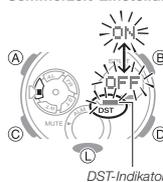
1. Halten Sie im Uhrzeitmodus (A) gedrückt, bis der blinkende SET-Indikator aus dem Display verschwindet und der aktuell gewählte Stadtcode im Display erscheint.
