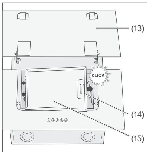
5. Setzen Sie den Fettfilter (15) mit den Zapfen in die Aussparungen.
