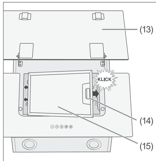
8. Setzen Sie den Fettfilter (15) mit den Zapfen in die Aussparungen.
