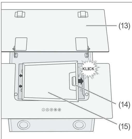
7. Setzen Sie den Fettfilter (15) mit den Zapfen in die Aussparungen.
