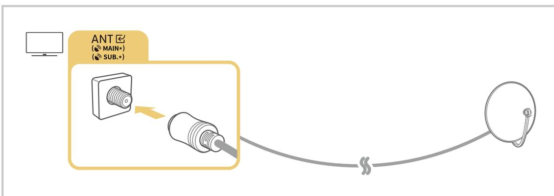
Am besten ist es, beide Anschlüsse mit einem Multischalter oder DiSEqC-Schalter usw. zu verbinden und den **Antennen-Verbindungstyp** auf **Dual** festzulegen.
