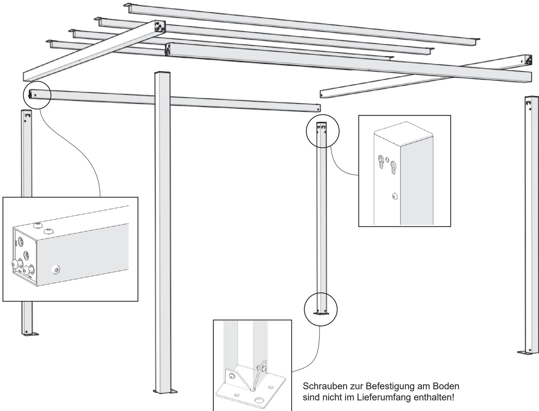
Schrauben zur Befestigung am Boden sind nicht im Lieferumfang enthalten!
