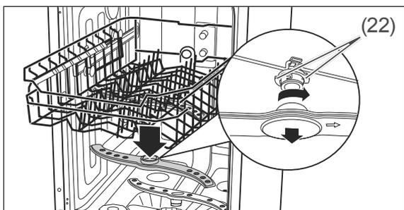
3. Der obere Sprüharm ist mit einem Bajonett-Verschluss befestigt. Zum Abnehmen des Sprüharms halten Sie die beiden gezackten Bajonettgriffe (22) fest und drehen Sie den Sprüharm im Uhrzeigersinn ab.
