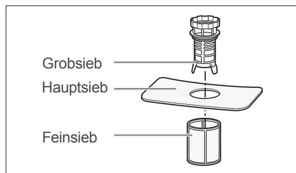
Überprüfen Sie nach jedem Spülgang das Grobsieb, das Hauptsieb und das Feinsieb, und entfernen Sie ggf. Speisereste und Fremdkörper:
