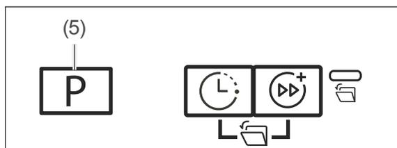
2. Halten Sie die Taste **P** (5) so lange gedrückt, bis im Display der aktuelle Härtegrad angezeigt wird: H1 bis H5.
