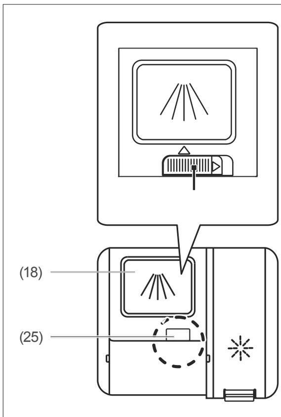
1. Schieben Sie den Verschluss (25) der Spülmittelkammer (18) zur Seite. Der Deckel springt auf.
