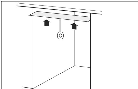
3. Kleben Sie die beiliegende Schutzfolie für Kondenswasser (c) auf die Unterseite der Arbeitsplatte. So vermeiden Sie Schäden an der Arbeitsplatte aufgrund heißer Dämpfe, die bei geöffneter Tür aus dem Geschirrspüler strömen.
