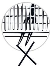
Beim Einladen des Bestecks darauf achten, dass das Besteck nicht durch den Boden des Besteckkorbs stößt. Der untere Sprüharm wird sonst blockiert.
