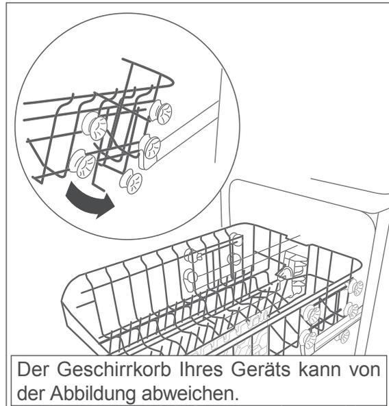
Wenn sich größere Geschirrtteile im unteren Geschirrkorb befinden, können diese den oberen Sprüharm behindern. Setzen Sie den oberen Geschirrkorb nach oben, um dies zu verhindern.
